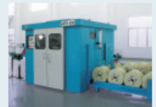
ASPS 500型 全自动双盘收线装置 Full automatic Double spooler
