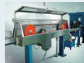
多道回线冷却牵引轮 Multi-pass cooling capstan
