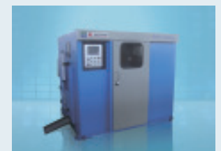
3S线用SPS 500/3型 自动双盘收线装置 Automatic Double spooler for Line 3S
